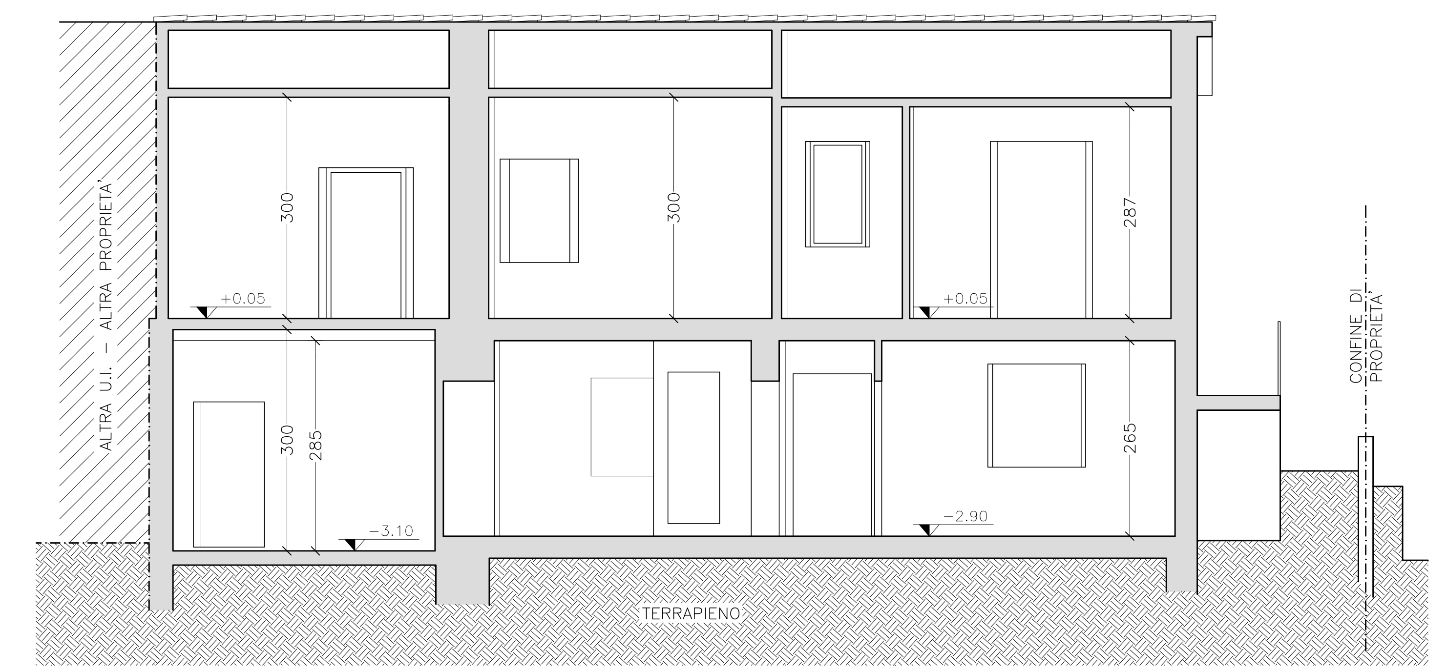
SEZIONE B-B STATO DI FATTO - SCALA 1:50
